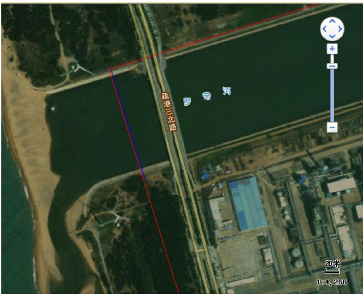
图 2.5-2 管道罗带河改建走向示意图（蓝色为改线部分）
