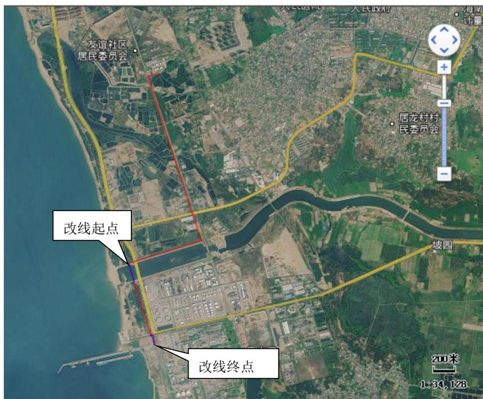
图 2.5-1 管道现状走向示意图（蓝色为改线部分）
