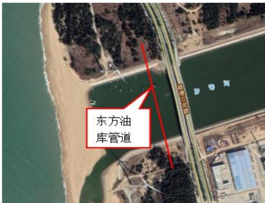
图 2.2-2 罗带河管线走向示意图
